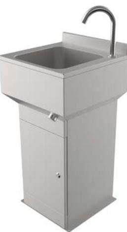
Бесконтактный умывальник с включением сенсорного типа напольного исполнения с пьедесталом, закрывающим подводку и сливную трубу расположенных ближе к полу. Подача воды активируется нажатием кнопки коленом. Регулировка температуры и потока воды. Отбортовка предотвращает затекание воды за умывальник.
