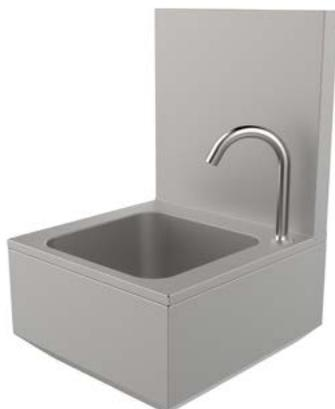
Бесконтактный умывальник с включением сенсорного типа настенного исполнения предназначен для мойки рук и инструмента. Подача воды активируется поднесением рук в зону срабатывания фотодатчика. Регулировка температуры и потока воды. Задняя стенка предотвращает затекание воды за умывальник, и защищает стену от брызг.
