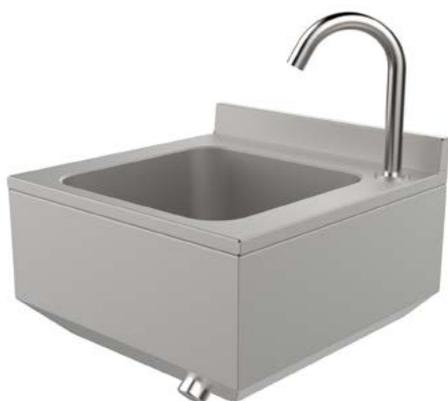
Бесконтактный умывальник с включением коленного типа настенного исполнения предназначен для мойки рук и инструмента. Подача воды активируется нажатием кнопки коленом. Регулировка температуры и потока воды. Отбортовка предотвращает затекание воды за умывальник.
