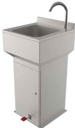
Бесконтактный умывальник с включением педального типа предназначен для мойки рук и инструмента. Подача воды активируется нажатием ногой на педаль. Регулировка температуры и потока воды. Отбортовка предотвращает затекание воды за умывальник.
