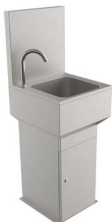
Бесконтактный умывальник с включением сенсорного типа, напольного исполнения с пьедесталом закрывающим подводку и сливную трубу расположенных ближе к полу, предназначен для мойки рук и инструмента. Подача воды активируется поднесением рук в зону срабатывания фотодатчика. Регулировка температуры и потока воды. Задняя стенка предотвращает затекание воды за умывальник и защищает стену от брызг.
