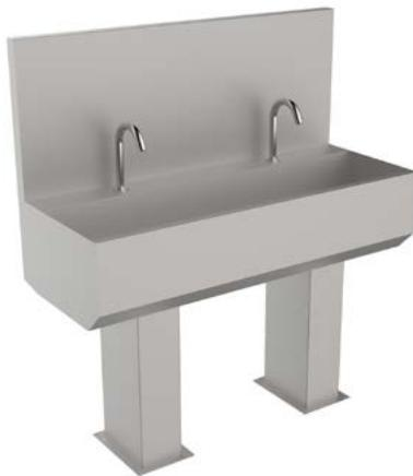
Бесконтактный умывальник на 2 поста, с включением сенсорного типа. Предназначен для мойки рук и инструмента. Подача воды активируется поднесением рук в зону срабатывания фотодатчика. Регулировка температуры и потока воды. Задняя стенка предотвращает затекание воды за умывальник и защищает стену от брызг.
