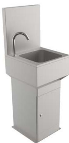
Бесконтактный умывальник с включением сенсорного типа, напольного исполнения с пьедесталом закрывающим подводку и сливную трубу расположенных ближе к полу, предназначен для мойки рук и инструмента. Подача воды активируется поднесением рук в зону срабатывания фотодатчика. Регулировка температуры и потока воды. Задняя стенка предотвращает затекание воды за умывальник и защищает стену от брызг.
