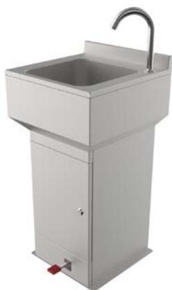
Бесконтактный умывальник с включением педального типа предназначен для мойки рук и инструмента. Подача воды активируется нажатием ногой на педаль. Регулировка температуры и потока воды. Отбортовка предотвращает затекание воды за умывальник.
