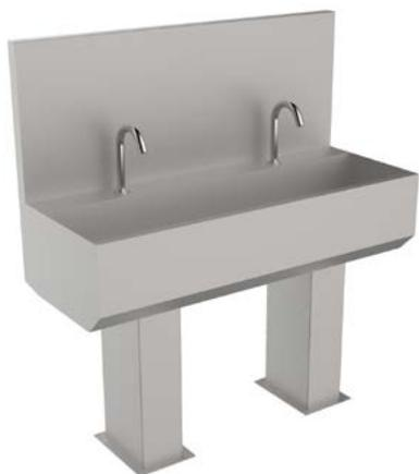
Бесконтактный умывальник на 2 поста, с включением сенсорного типа. Предназначен для мойки рук и инструмента. Подача воды активируется поднесением рук в зону срабатывания фотодатчика. Регулировка температуры и потока воды. Задняя стенка предотвращает затекание воды за умывальник и защищает стену от брызг.
