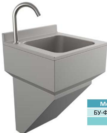
Бесконтактный умывальник с включением сенсорного типа настенного исполнения с полупьедесталом, закрывающим подводку и сливную трубу расположенных в стене. Подача воды активируется поднесением рук в зону срабатывания фотодатчика. Регулировка температуры и потока воды. Отбортовка предотвращает затекание воды за умывальник.
