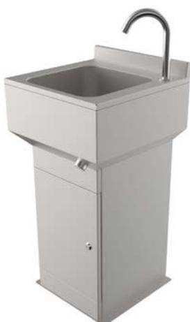
Бесконтактный умывальник с включением сенсорного типа напольного исполнения с пьедесталом, закрывающим подводку и сливную трубу расположенных ближе к полу. Подача воды активируется нажатием кнопки коленом. Регулировка температуры и потока воды. Отбортовка предотвращает затекание воды за умывальник.
