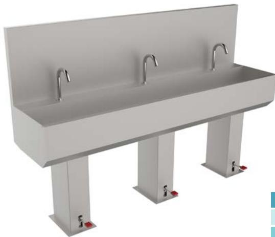
Бесконтактный умывальник на 3 поста, с включением педального типа предназначен для мойки рук и инструмента. Подача воды активируется нажатием ногой на педаль. Регулировка температуры и потока воды. Задняя стенка предотвращает затекание воды за умывальник и защищает стену от брызг.
